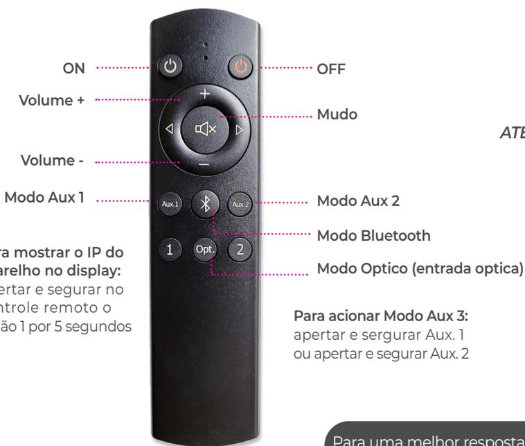
Para mostrar o IP do aparelho no display: Apertar e segurar no controle remoto o botão 1 por 5 segundos
