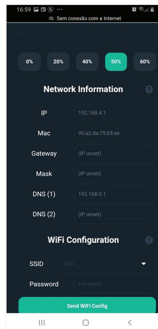
Para configurar o equipamento na rede local, clicar na seta do campo **SSID**
